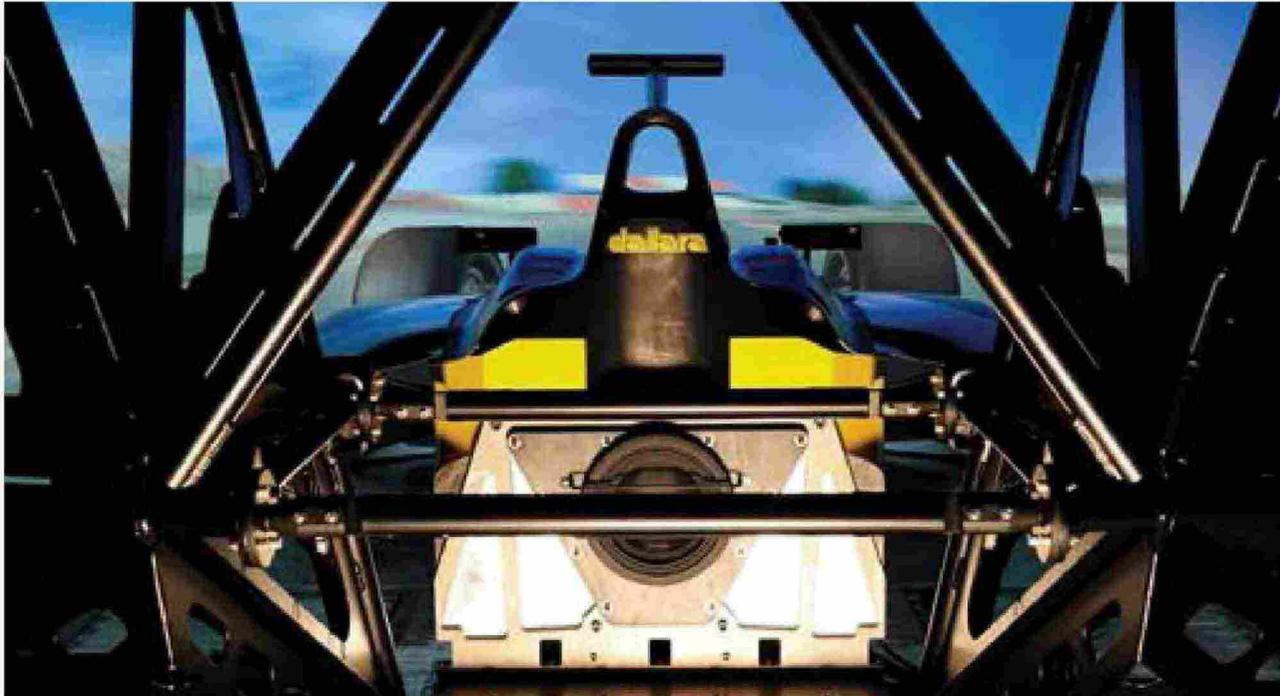
Il Simulatore di guida offre la possibilità di guidare delle vetture che non sono ancora state costruite, grazie a dei modelli matematici che riproducono in modo fedele la realtà. Questo tipo di modello viene definito "Human in The Loop", cioè l'uomo al centro di un'interazione tra mondo reale e mondo virtuale
