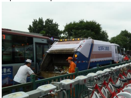
Figura 10: compattatore caricato manualmente
